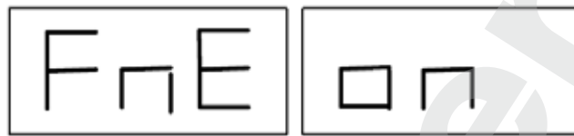
Рис. 8.0а Включение высокого разрешения дисбаланса на дисплее
