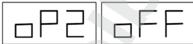
Рис. 7.2 - Отключение памяти оператора 2. Память оператора 1 восстанавливается
