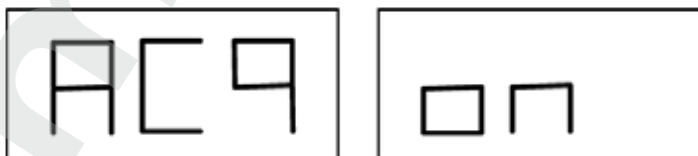
Рис. 3.10 Сообщение "Выбор балансировочной плоскости включен"
