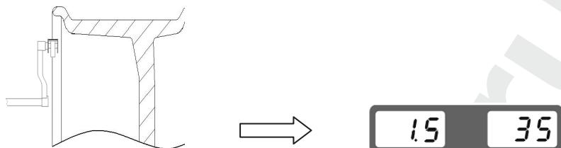
5. Когда линейка достигнет нужного положения, значение дисбаланса на левом дисплее заморгает. Вращая колесо рукой, установите его в положение, когда все светодиоды позиционирования на панели горят. Коснитесь наконечником линейки поверхности диска и прижмите грузик в положение установки, после этого вставьте линейку на место.
