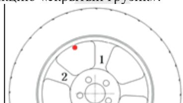
2. На дисплее отобразится “SPO.--1”. Вытяните линейку и коснитесь ее наконечником поверхности диска за спицей 1, удерживая колесо. Установите линейку на место и нажмите кнопку ABD для подтверждения.
