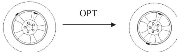
Когда в режиме статической балансировки (STA) значение дисбаланса превышает 30 г, индикатор функции OPT загорается, чтобы показать, что станок вошел в режим оптимизации.
