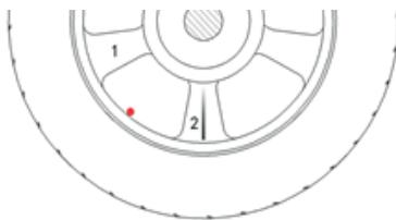
4. Теперь внешний грузик разделен на два грузика, размещенных за спицами. Нажмите кнопку ABD для переключения между этими двумя грузиками. Используя линейку для нанесения грузиков, установите самоклеящиеся грузики на внутреннюю и внешнюю поверхность диска.
