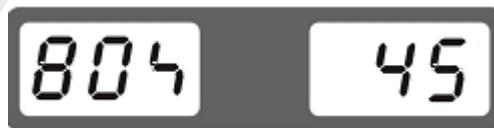
Левый дисплей отображает процент статического дисбаланса, который можно убрать путем перемещения шины относительно диска (знак «%» отображается как ).
