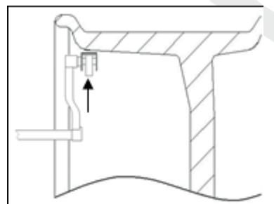
6. Вращая колесо рукой, установите его в положение, когда все светодиоды позиционирования на панели горят. Удерживая колесо в данной позиции, установите грузик в положение A1.
