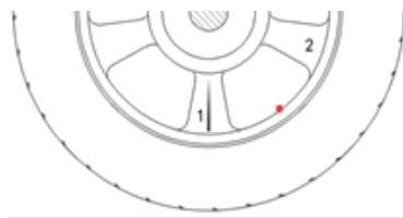
3. На дисплее отобразится “SPO.--2”. Вытяните линейку и коснитесь ее наконечником поверхности диска за спицей 2, удерживая колесо. Установите линейку на место и нажмите кнопку ABD для подтверждения.
