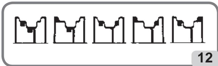
Существуют разнообразные программы балансировки ALU, предназначенные специально для работы с таким видом колес.
