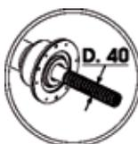
Использовать дополнительные детали для центрирования с диаметром отверстия 40 мм.
