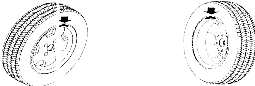
Мал.11 Корегування дисбалансу ззовні Мал.12 Корегування дисбалансу зсередини
