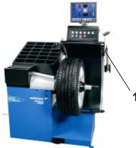
Рисунок 2 – Расположение ультразвукового датчика для автоматического определения ширины обода
