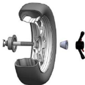
Главный вал → Колесо ( направление поверхности установки обода - внутри) → Конус → Быстросъемная гайка
