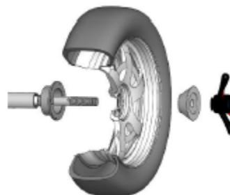
Главный вал → колесо (обод обращён внутрь колеса) → центровочный конус → быстросъемная гайка
