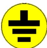
**Символ заземления:** табличка, расположенная слева на задней панели, указывает место подсоединения кабеля заземления
