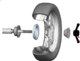
Главный вал → диск с фланцем (зафиксирован на главном валу) → конус → быстросъемная гайка.
