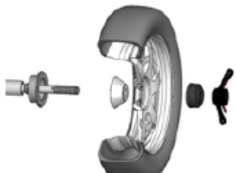
Главный вал → пружина → центровочный конус → быстросъемная гайка
